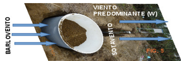
Figura 5. Ubicación del tanque de cultivo del lisímetro en sotavento del campo experimental.
