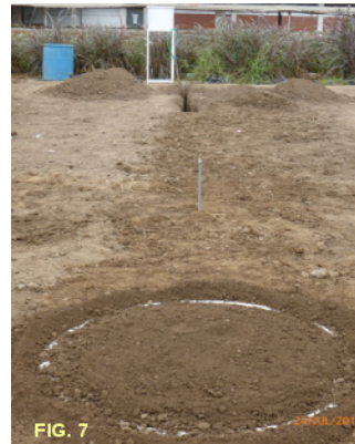
Figura 7. Equipo de lisímetro instalado listo para la calibración.
