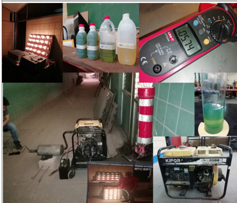
Figura 1. Esquema del sistema para la prueba experimental del grupo motor generador y medición de emisiones
