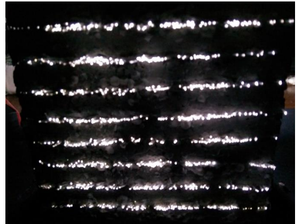
Figura 5. Prueba de traslucidez en probeta con 3% de fibra añadida. Véase las FOP conduciendo los haces de luz.
