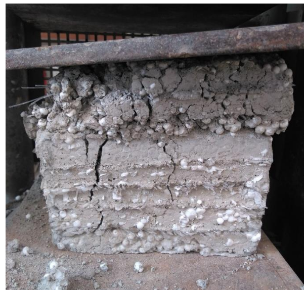
Figura 6. Prueba de compresión realizada en probeta con 3% de fibra añadida.
