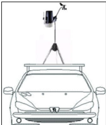
Figura 1. Modelo de la instalación del equipo de monitoreo
